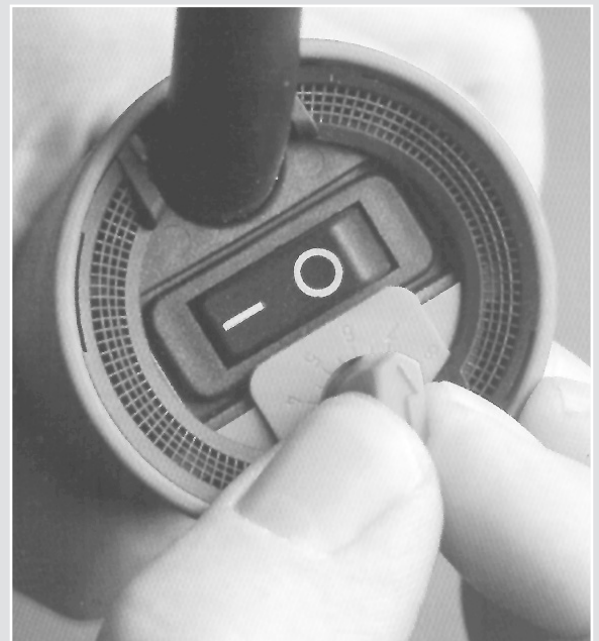
Der Potentiometerknopf an der Rückseite des Heissluftschweissgerätes ermöglicht eine genaue Regelung der Schweisstemperatur bis 700° C.
